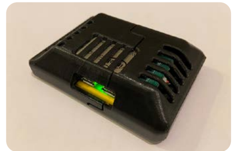
Das Foto zeigt die Steuereinheit des an der TH Aschaffenburg selbstgebautes Closed-Loop-Systems. Bild: Jonas Busch
