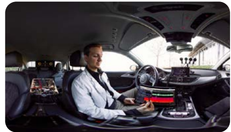
Stefan Ciba M.Sc., wissenschaftlicher Mitarbeiter der TH AB, bei akustischen Versuchen zur Verbesserung der Sprachverständlichkeit mittels InterCom-System im Innenraum eines Forschungsfahrzeuges (Projekt Vespah)
